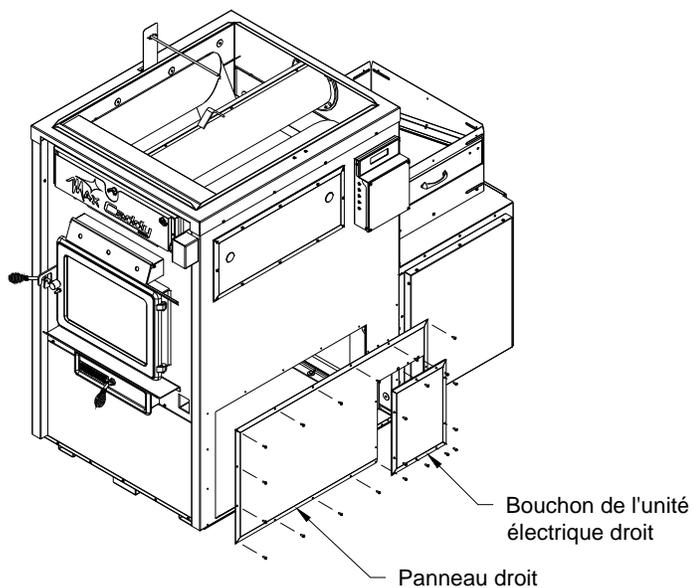
Étape 4 : Retirez le bouchon de l'unité électrique gauche et le panneau gauche situés à gauche de la fournaise en dévissant les vis qui les maintiennent en place. Gardez ces vis.
