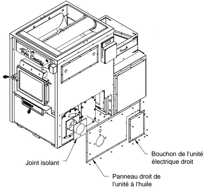
Étape 8 : Remettez le capuchon sur le tube de vision que vous avez retiré à l'étape 2. Installez le brûleur à l'aide des écrous et rondelles fournis avec l'unité à l'huile tel qu'illustré à droite. Il est important de coller la plaque d'homologation à côté du brûleur.
