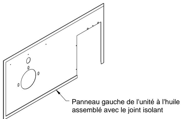
Étape 8 : Avant d'installer le panneau, veuillez mettre le joint isolant sur l'unité à l'huile. Revissez en place le panneau gauche de l'unité à l'huile. Revissez le bouchon de l'unité électrique gauche que vous aviez retiré à l'étape 4.
