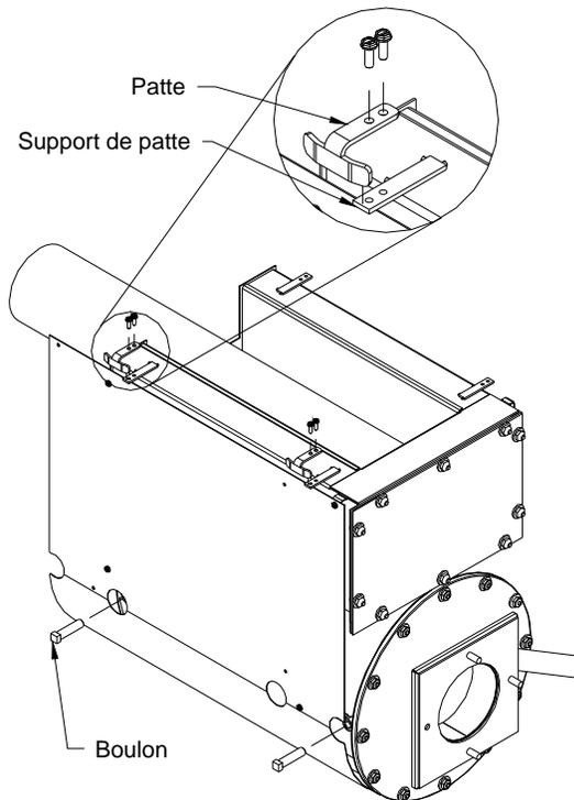
Étape 4 : Retirez le bouchon de l'unité électrique gauche et le panneau gauche situé à gauche de la fournaise en dévissant les vis les maintenant en place. Gardez ces vis.
