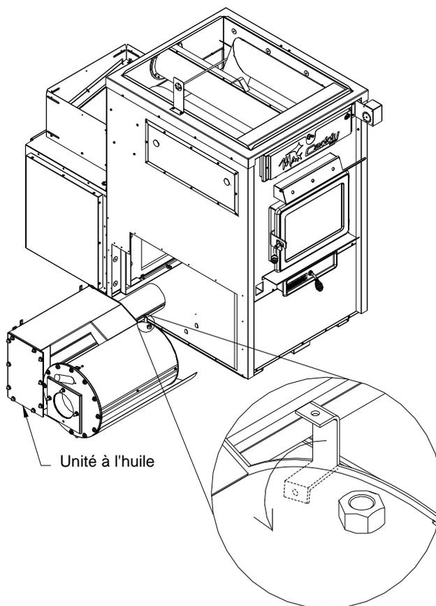
Étape 7 : Installez le joint isolant sur le panneau gauche fourni avec l'unité à l'huile.
