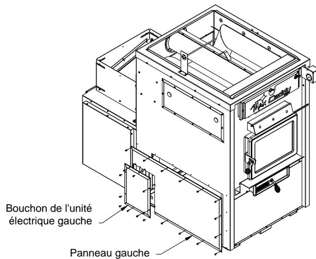
Étape 5 : Retirez le bouchon de l'unité électrique et le panneau droit situé à droite de la fournaise en dévissant les vis les maintenant en place. Gardez ces vis.
