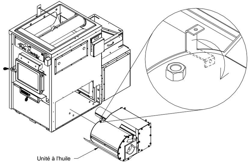
Étape 6 : Installez le joint isolant sur le panneau droit fourni avec l'unité à l'huile.
